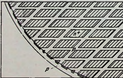
Fig. 8 - Dit ingediffundeerde lagen.
