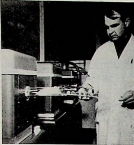
Afb. 7 - Het inbrengen van de siliciumplakken in de oxydeer-oven.
