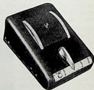
Een oproep-luister/spreek apparaat van het intercomsysteem „Call-Phone”.
